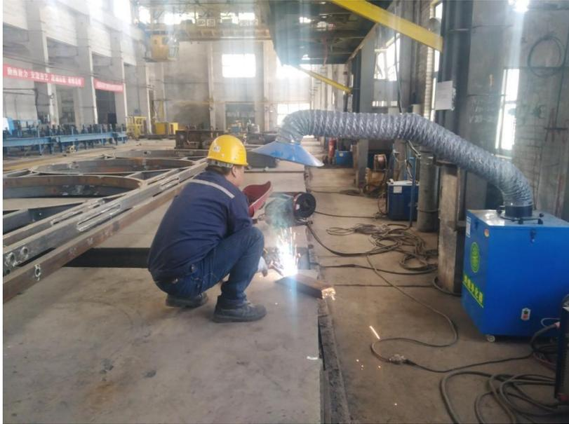
图 4-2 焊接烟尘废气处理设施
