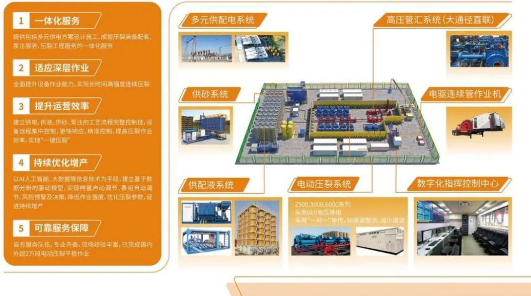
全电动压裂一体化解决方案由电驱连续管作业机、数字化指挥控制中心、电动压裂系统、高压管汇系统、供配液系统、供砂系统和多元供配电系统七部分组成，具有一体化服务、适应深层作业、提升运营效率、持续优化增产和可靠服务保障等特点，助力非常规油气开发迈向绿色、智能新时代。
