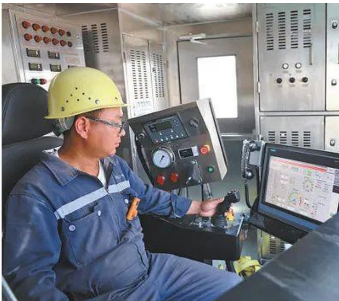
在 750HP 快速移运钻修一体钻机司钻房内，工程师正在调试系统（人民日报记者张志文 摄）
